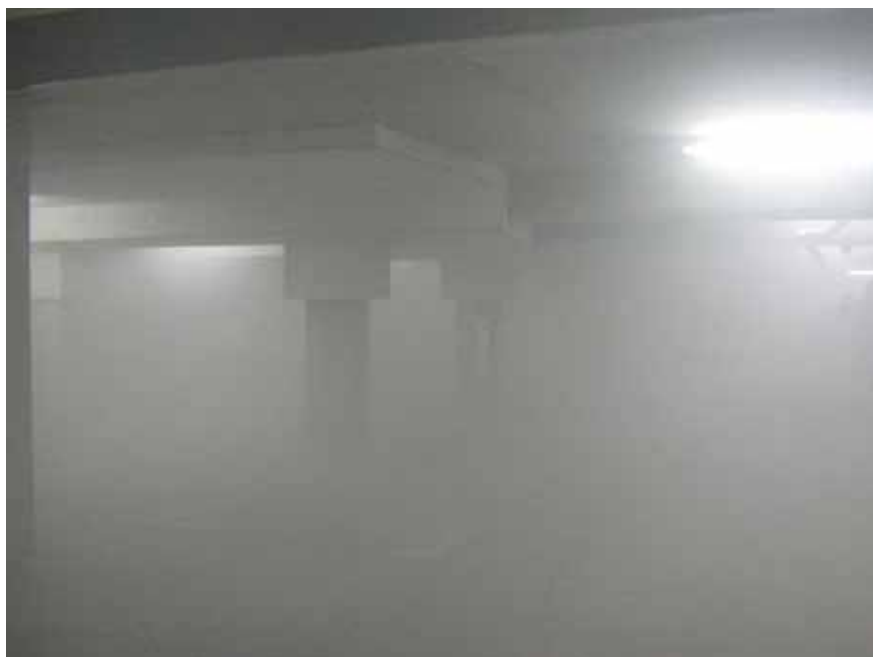
Parkeergarage met rookbelemmering; de zichtlengte voor niet-lichtgevende voorwerpen bedraagt hier gemiddeld ongeveer vijf meter.
